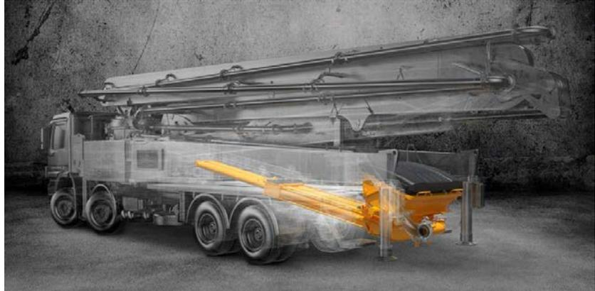
La majorité des pompages sont effectués au moyens de camions pompes avec des mats de 20 à 65m, de camions malaxeurs pompes ainsi que de pompes stationnaires pour les gros chantiers avec des conduites de distribution en acier couplés avec des épandeurs giratoires (girafes) ou des mats stationnaires.
